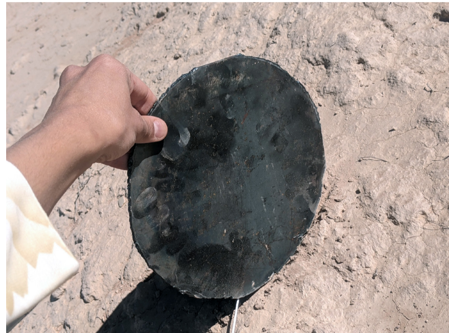
Tout le désert sur un 7" (documentation, instrument d'écoute), plaque circulaire en acier, accéléromètre, particules de sable, vent, désert Jornada, 2021.
